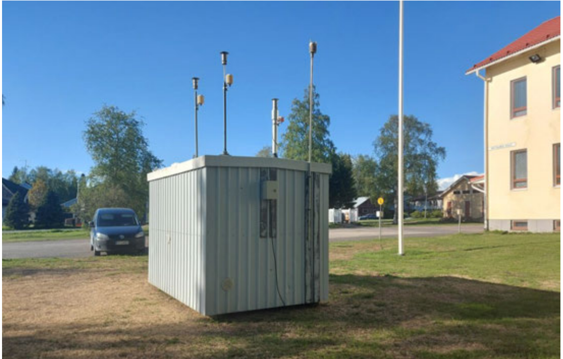
Kuva 36. Tornion Näätsaaren ilmanlaadun mittauspiste. Ulkoilma imetään mittalaitteisiin kontin katolla sijaitsevien näytteenottimien läpi. Lisäksi katolla on säämittausanturi. Valokuva: Matias Saunamäki.
