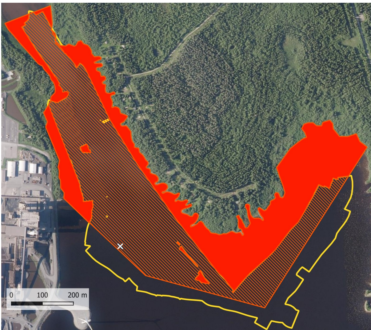
Kartta 4. Tutkitun alueen kokonaislaajuus oranssilla vinoviivoituksella ja viistokaikuluotauksen kokonaiskattavuus keltaisella. Punainen alue jäi kaikuluotauksen ulottumattomiin merenpohjan mataluuden ja karikkojen vuoksi. Valkoinen ruksi osoittaa sukellustarkastetun anomalian sijainnin. Taustakartta Maanmittauslaitoksen ortoilmakuvarasteri 12/2025 aineistoja. Laatija: Aki Hakonen.
