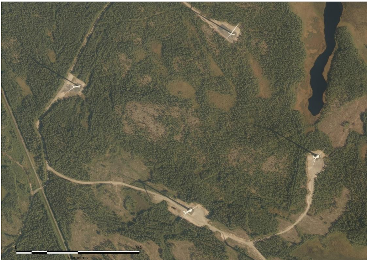
Bild 10. Flygfotot visar vindkraftverk som redan är i drift. Servicevägar och lyftfält har byggts för vindkraftverken. Markanvändningen i vindkraftverkens omgivning och mellanområden har bevarats i sin ursprungliga form.
